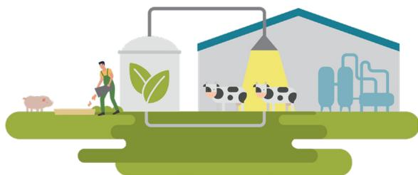
*El biogás es un combustible generado por la descomposición anaeróbica de residuos orgánicos, gracias al trabajo de bacterias. Este biocombustible puede ser utilizado para generar energía eléctrica y/o térmica, así como para la elaboración de otros combustibles.*
